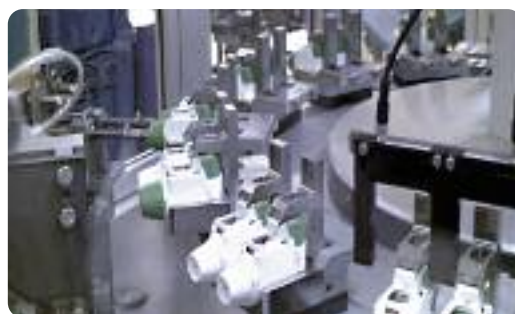
Unidad dosificadora de la línea de llenado comercial.
